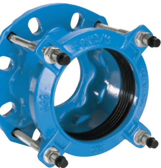
AVK Supa® - универсальные прямые, редукционные муфты и фланцевые адаптеры предназначены для труб из НПВХ, серого и высокопрочного чугуна, стали и асбестоцемента. Диапазон размеров соединителей DN40-400. Подходят для применения в сетях водоснабжения и сточных вод.
