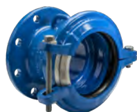
Серия 653/00 Supra One™ фланцевый адаптер Для чугунных, стальных, ПВХ и ПЭ труб Высокопрочный чугун DN80-200 PN16
