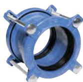
Серия 601 Supra® прямая муфта Для ПНВХ, асбестоцементных, стальных и чугунных труб Высокопрочный чугун DN40-400 PN16
