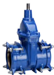
Серия 01/70 Supra Plus™ задвижка клиновая с муфтами Фиксирующего типа для ПЭ и НПВХ труб Высокопрочный чугун DN40-300 PN16
