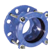
Серия 601 Supra® прямая муфта Для ПНВХ, асбестоцементных, стальных и чугунных труб Высокопрочный чугун DN40-400 PN16
