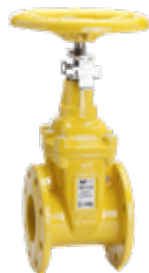
Серия 06/59 Фланцевое клиновое устройство с индикатором положения Короткая DIN F4 DN50-400 PN10/16 Высокопрочный чугун С эпоксидным покрытием
