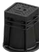
Серия 80/34-000 Ковер для клиновых задвижек По DIN 3581 Нерегулируемый Корпус из PA+ Крышка из чугуна
