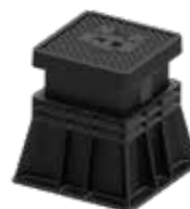
Серия 80/35 Ковер для клиновых задвижек По DIN 3582 Регулируемый Усиленный обод Корпус из PA+ Крышка из чугуна
