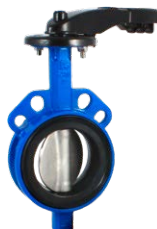
Серия 820/00 Затвор дисковый поворотный Со сменным уплотнением Тип Wafer DN25-1000 PN10/16 Высокопрочный чугун
