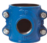
Серия 10/00 Хомутовой отвод для ПЭ и ПВХ труб DN50-300 Высокопрочный чугун Нижняя секция из нержавеющей стали с DN250 включительно
