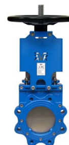
Серия 702/20 Задвижка шиберная с маховиком и выдвижным штоком DN50-1200 PN10 Высокопрочный чугун
