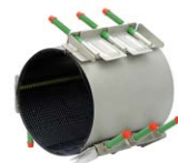
Серия 748/03 Муфта ремонтная трехсоставная Нержавеющая сталь AISI 304 или AISI 316 Резиновая прокладка из NBR или EPDM
