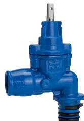
Серия 103/31 Задвижка ответвительная угловая Supra Lock™ патрубок/муфта для ПЭ труб DN32 Для ПЭ труб Ø32-40 мм PN16 Высокопрочный чугун
