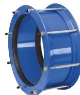
Серия 258 Муфта обжимная для труб из асбестоцемента, чугуна и стали Сталь DN350-2000 PN8 to 25
