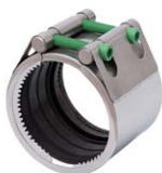
Серия 745/01 Соединитель Repico® фиксирующего типа, для всех видов металлических труб Нержавеющая сталь AISI 316 Уплотнение из NBR или EPDM DN15-400
