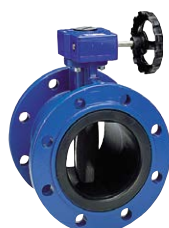
Серия 75/20 Затвор дисковый поворотный С несъемным уплотнением Двухфланцевый короткий DN50-2000 PN10/16 Высокопрочный чугун
