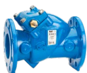
Серия 41/60 Клапан обратный дисковый, с упругим запиранием С хвостовиком DN50-300 PN10/16 Высокопрочный чугун
