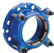
Серия 623/10 Адаптер фланцевый Supa Plus™ фиксирующего типа, для ПЭ и ПВХ труб DN40-300 PN10/16 Высокопрочный чугун
