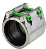
Серия 745/20 Соединитель Repico® нефиксирующего типа для всех видов труб Нержавеющая сталь AISI 316 Уплотнение из NBR или EPDM DN15-600
