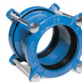
Серия 601 Муфта Supa® универсальная DN40-400 PN16 Высокопрочный чугун
