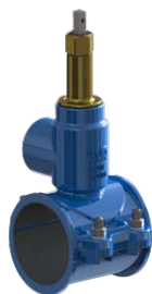
Серия 727/09 Хомутовой отвод SWIC для врезки под давлением С интегрированным сверлом для ПЭ и ПВХ труб DN50-200
