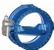
Серия 756/102 Затвор дисковый поворотный Двухэксцентриковый С седлом из нержавеющей стали Редуктор с выходным фланцем ISO DN150-2800 PN10/16 Высокопрочный чугун
