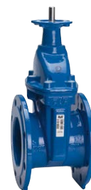
Серия 15/42 Задвижка клиновья фланцевая под электропривод Короткая по DIN F4 DN40-400 PN10/16 Высокопрочный чугун
