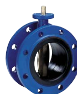
Серия 75/20 Затвор дисковый поворотный С несъемным уплотнением Двухфланцевый короткий DN50-2000 PN10/16 Высокопрочный чугун
