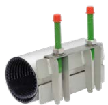
Серия 748/01 Муфта ремонтная односоставная Нержавеющая сталь AISI 304 или AISI 316 Резиновая прокладка из NBR или EPDM
