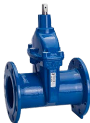
Серия 02/60 Задвижка клиновая фланцевая с увеличенной строительной длиной по DIN F5 DN40-500 PN10/16 Высокопрочный чугун
