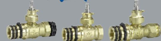
В шаровых латунных кранах используется шар с седлом из PTFE. Данные краны доступны в трех модификациях: патрубок Supra Lock™ и внутренняя резьба, муфта PRK, или специальный резьбовой фитинг для ПЭ труб.
