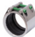
Серия 745/01 Соединитель Рерисо® Фиксирующего типа для всех видов метал. труб Уплотнение NBR или EPDM DN15-400 Нерж. сталь AISI 316
