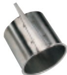
Серия 05 Поддерживающая втулка для ПЭ труб Подходит для Supa Maxi™, Supa Plus™ и фланцев комби Нержавеющая сталь DN50-600 PN6.3/10/16
