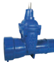
Серия 33/50 Задвижка клиновая с муфтой и патрубком BLS® для чугунных труб DN80-300 PN16 Высокопрочный чугун
