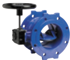
Серия 756/100 Затвор дисковый поворотный Двухэксцентриковый С интегрированным седлом DN200-2800 PN10/16 Высокопрочный чугун
