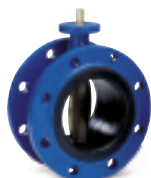
Серия 75/21 Затвор дисковый поворотный С несъемным уплотнением Двухфланцевый длинный DN50-1500 PN10/16 Высокопрочный чугун
