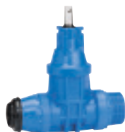
Серия 16/29 Задвижка ответвительная Фиксирующая муфта для ПЭ труб/ наружная резьба DN25-50 PN16 ПОМ (Полиоксиметилен)
