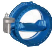
Серия 756/102 Затвор дисковый поворотный Двухэксцентриковый С седлом из нержавеющей стали Редуктор с выходным фланцем ISO DN200-2800 PN10/16 Высокопрочный чугун
