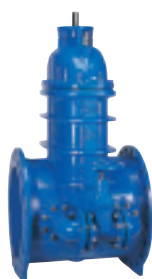
Серия 55/30 Задвижка клиновая фланцевая DN450-500-600-800 Строительная длина по DIN F5 PN10/16 Высокопрочный чугун С обрезиненным клином Заменяемое уплотнение штока
