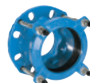
Серия 603 Фланцевый адаптер Supra® Нефиксирующего типа для ПВХ, стальных и чугунных труб Универсальная рассверловка Высокопрочный чугун DN40-400 PN10/16
