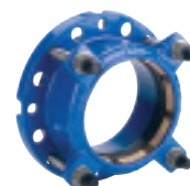
Серия 623/10 Фланцевый адаптер Supra Plus™ Фиксирующего типа для ПЭ и ПВХ труб Универсальная рассверловка Высокопрочный чугун DN40-300 PN10/16
