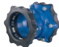
Серия 632 Муфта переходная Supra Maxi™ Фиксирующего типа для всех видов труб Высокопрочный чугун DN50-300 PN16
