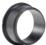
Серия 05 Уплотнение фланца комби для ПВХ, стальных и чугунных труб Не фиксирующего типа Резина SBR DN400-600 (ПВХ и чугунные трубы) DN50-300 (стальные трубы)
