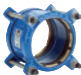
Серия 621/10 Муфта Supra Plus™ Фиксирующего типа для ПЭ и ПВХ труб Высокопрочный чугун DN32-300 PN16
