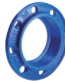
Серия 05 Фланец комби для ПВХ, чугунных и стальных труб Нефиксирующего типа Высокопрочный чугун DN400-600 (ПВХ и чугунные трубы) DN50-300 (стальные трубы) PN10/16
