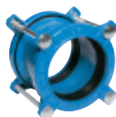
Серия 601 Муфта Supra® Нефиксирующего типа для ПВХ, стальных и чугунных труб Высокопрочный чугун DN40-400 PN16
