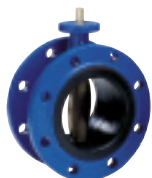
Серия 75/20 Затвор дисковый поворотный С несъемным уплотнением Двухфланцевый короткий DN50-2000 PN10/16 Высокопрочный чугун
