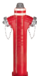
Серия 84/05 Гидрант надземный пожарный Безаварийного типа с дополнительным перекрывающим клапаном Model P7 DN80/100 PN16 Высокопрочный чугун
