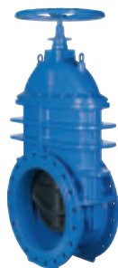
Серия 06/30 Задвижка клиновая фланцевая с уменьшенной строительной длиной по DIN F4 DN450-1000 PN10/16 Высокопрочный чугун Заменяемое уплотнение штока
