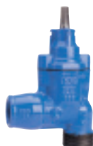
Серия 11/30 Задвижка ответвительная угловая с муфтой для ПЭ труб и наружной резьбой DN25-50 PN16 Высокопрочный чугун
